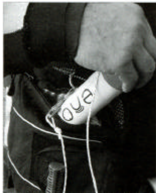
Abb. 1: Der Sender hat die Größe einer kleinen Taucherlampe und kann einfach im Jacket verstaut werden
