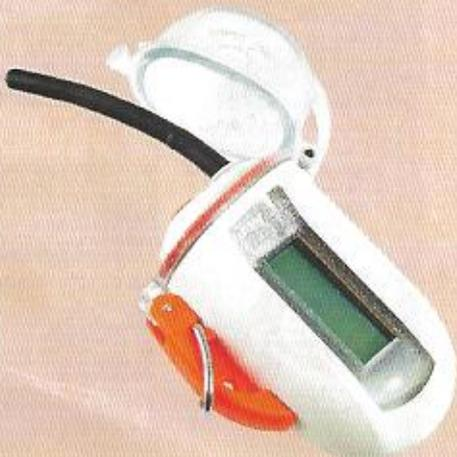
Das Seasafe ist ein australisches Rettungssystem, ursprünglich ein Man-über-Bord-System, bei dem das Signal (Notruf) auf dem Schiff eingeht. Dieses Signal muss vom Schiff aus manuell angepeilt werden. Aus der akustischen Stärke wird die ungefähre Entfernung abgeschätzt. Keine Registrierung notwendig.
