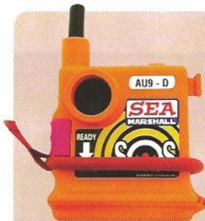
Das Sea Marshall-System, ursprünglich als Man-über-Bord-System entwickelt, ist ein Peilsystem, bei dem der Notruf auf dem Schiff eingeht. Es erfordert eine spezielle Antenne, die die Richtung des Notrufs erkennt und mithilfe einer LED auf einem Anzeigen-Kreis des Empfängers die ungefähre Richtung anzeigt, aus der der Notruf kommt. Die Entfernung lässt sich nur aus der Signalstärke abschätzen. Keine Registrierung notwendig.
