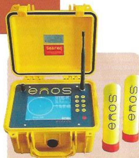
Das ENOS-System ist ein Rettungssystem, das speziell für den Tauchsport entwickelt wurde. Die Notrufübertragung mit GPS erfolgt auf lizenzfreien Funkfrequenzen direkt zum Tauchschiff. Geht ein Notruf ein, erfolgt eine akustische Alarmierung und eine grafische und tabellarische Anzeige mit Entfernung und Richtung zum Taucher auf dem Empfänger. Gehen mehrere Notrufe aus unterschiedlichen Richtungen ein, können diese gleichzeitig verarbeitet werden. Keine Registrierung notwendig.
